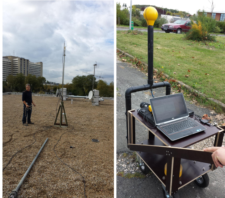
FIGURE 13.5 – Antenne d'émission et plateforme mobile d'acquisition
